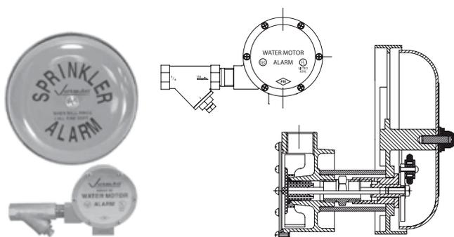
La campana idraulica è un dispositivo ad azionamento meccanico che suona quando si verifica un flusso sostenuto di acqua (come con uno o più sprinkler aperti).
