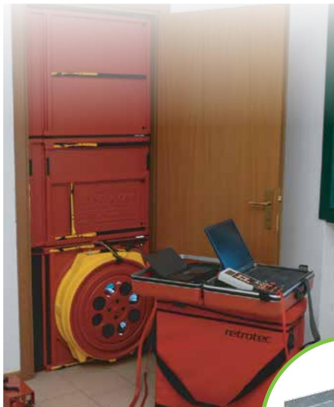
Il Door Fan Integrity Test è una prova che viene effettuata per verificare e certificare che, la concentrazione di spegnimento all'interno del locale da proteggere, venga mantenuta per almeno 10 minuti. Questo test è previsto obbligatoriamente dalla UNI EN 15004, sia in fase di installazione di nuovo impianto, sia in fase di manutenzione, quando non si ha la certezza che non siano stati effettuati attraversamenti murari o altri cambiamenti al volume protetto.
