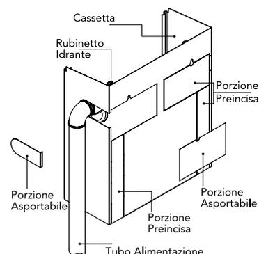
Togliendo le lamiere pretagliate sul lato e sul retro della cassetta la si può installare con la tubazione all'esterno della stessa senza dover smontare il rubinetto.
