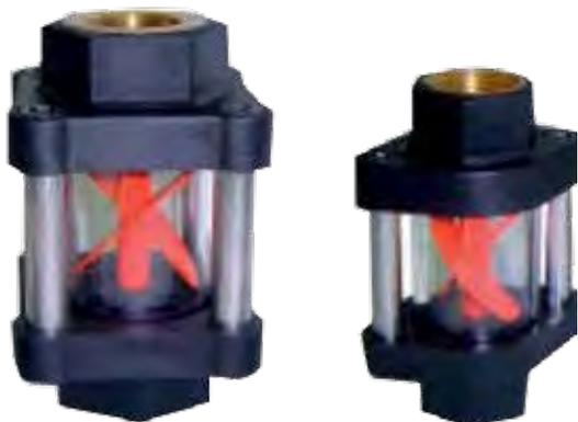
Accessorio per il dispositivo di ANTI-SURRISCALDAMENTO per le pompe antincendio UNI EN 12845 e UNI 10779 Permette il controllo visivo del passaggio del liquido per le pompe antincendio in funzione e con la mandata chiusa. L'elica è colorata e migliora la visualizzazione anche con liquidi opachi.
