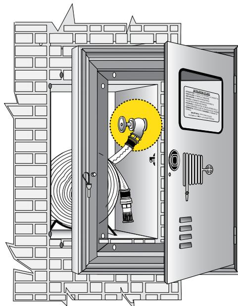
Quando lo spazio per l'installazione dei rubinetti all'interno di cassette e nicchie a muro è troppo angusto e non permette la rotazione del rubinetto per avvitarlo al tubo di alimentazione, l'installazione della ghiera girevole risolve il problema contenendo le spese.
