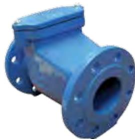
Valvola di ritegno a clapet flangiata PN 16. Corpo in ghisa GJL500. Potenza massima esercitata 16 BAR Temperatura massima di esercizio: -10°C + 80°C Flangia UNI - EN 1092.
